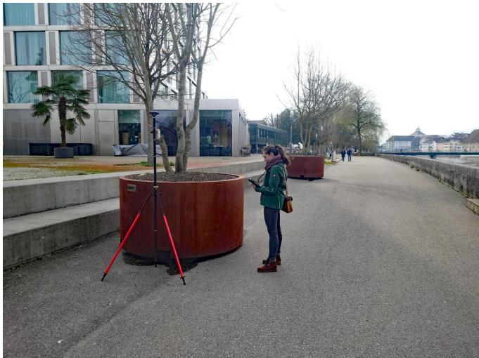
Eine Mitarbeiterin der BFH bei der Erstellung eines 3D-Modells: LiDAR (Light Detection and Ranging) erstellt mithilfe von Laserimpulsen hochpräzise 3D-Modelle der Umgebung.
