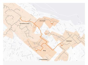
Als zweiter Schritt werden die Wärmeverbünde Burg, Brunnmatt und Hallenbad an die modernisierte Heizzentrale angeschlossen. Der Grosswärmeverbund Liestal wird nach Ausbau und Zusammenschluss rund 31 Kilometer umfassen.
