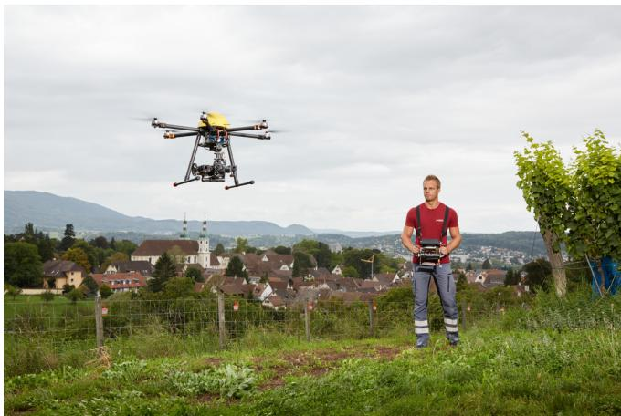
Digitales Scannen der Umwelt mit Drohnen: Eine Drohne scannt die Umwelt mittels 3D-Laser und übermittelt präzise digitale Vermessungsdaten direkt in die Cloud.
