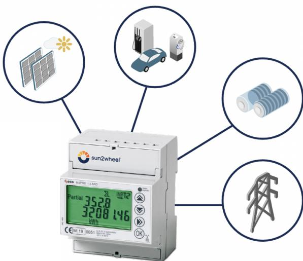
Der sun2wheel V2X-controller ermöglicht, dass eAutos mit lokal produziertem Solarstrom geladen werden können.
