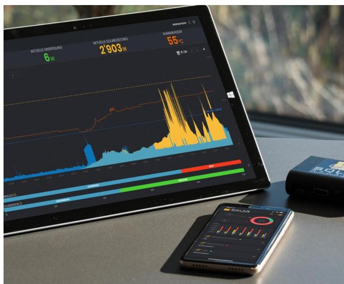
Damit jederzeit sichtbar ist, ob ein Überschuss besteht oder ob Strom aus dem Netz bezogen wird, bietet der Solar Manager eine Visualisierung der wichtigsten Kennzahlen.
