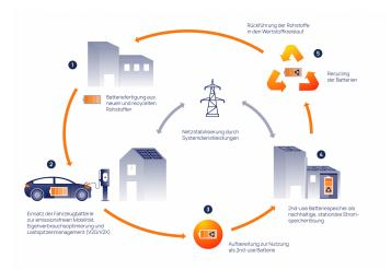
Der Lebenszyklus einer Fahrzeugbatterie und die Verwendung als second-use Batteriespeicher.
