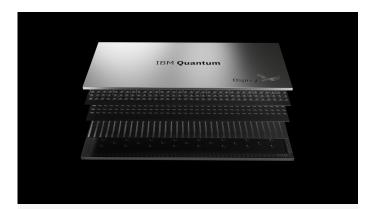
Ein Schnitt durch den Osprey-Prozessor, der bisher leistungsstärkste Quantencomputer. Dieser besitzt 433 Qubit, auf die QuantumBasel Zugriff erhält.
