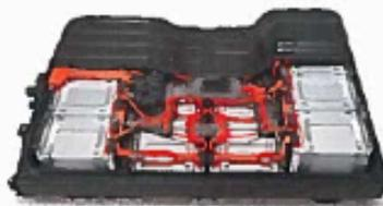
Ausgediente Fahrzeugbatterien lassen sich zu nachhaltigen Second-Use-Batteriespeichern umnutzen.
